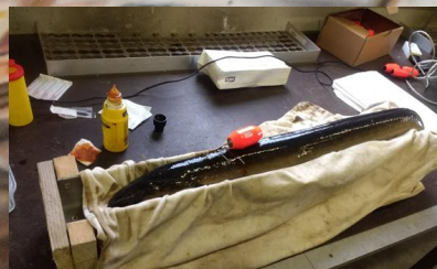
De datalogger wordt op de rug van de paling gemonteerd. © Pieterjan Verhelst
